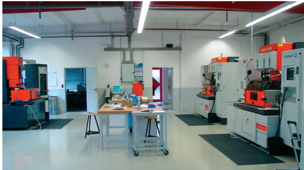
Platz für mehr: In der großzügigen Halle stehen bei WiKa bis jetzt die beiden Robofil 2030SI, eine ältere Robofil 200 und eine Hochpräzisions-Flach- und Profilschleifmaschine Jung JE 525. Eine Senkerodiermaschine steht als nächstes auf dem Wunschzettel.
